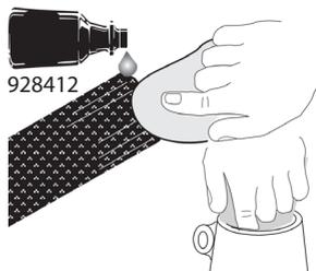
Limpe minuciosamente a extremidade do tubo de fibra de carbono e o interior da estrutura de fixação. Utilize uma solução de limpeza adequada como a acetona (928412). Deixe secar. NÃO MANUSEIE AS ÁREAS JÁ LIMPAS.
