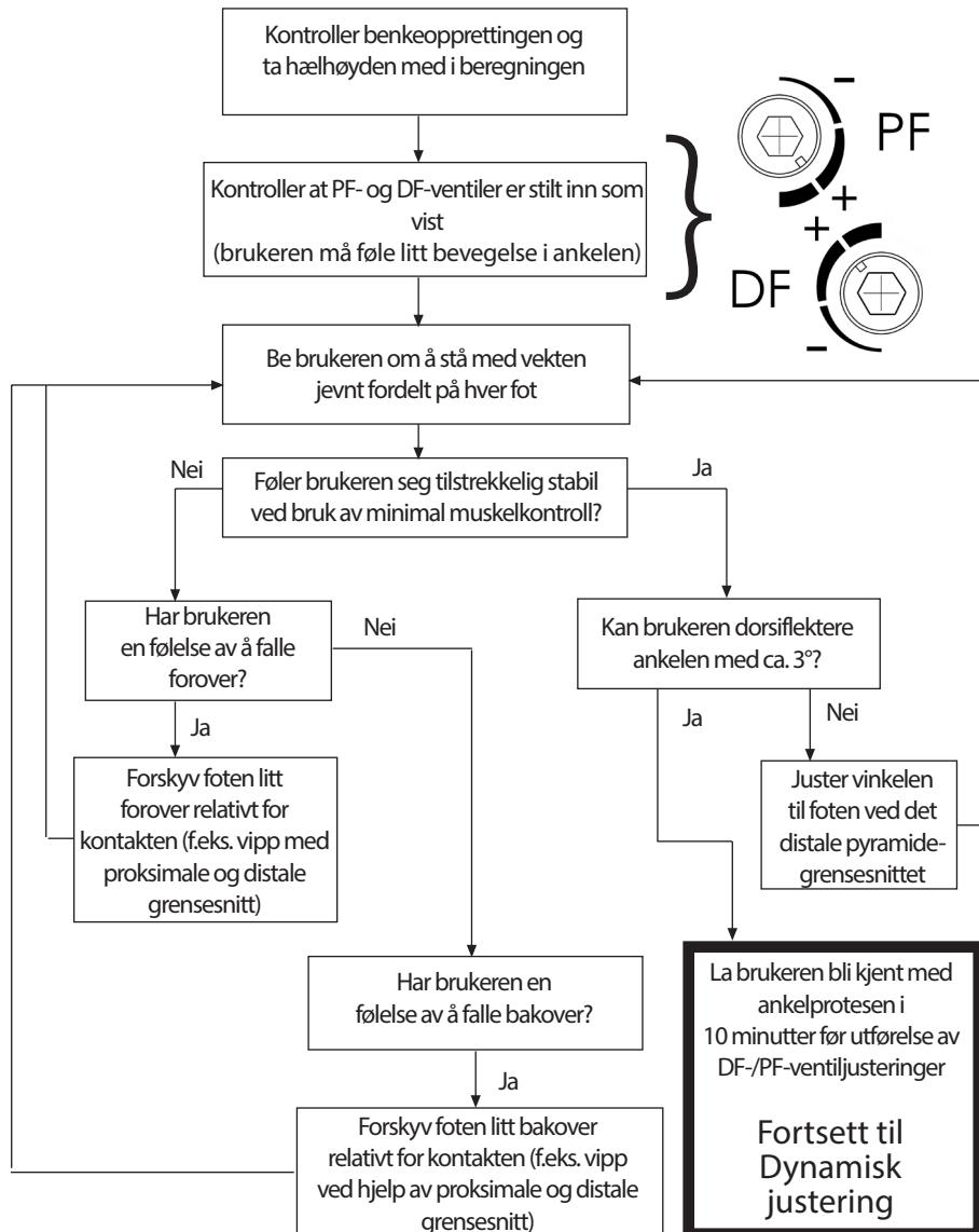
Bruk forskyvning for statisk justering og ståstilling.
