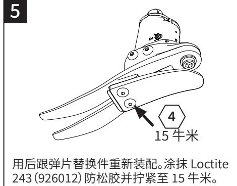
用后跟弹片替换件重新装配。涂抹 Loctite 243 (926012) 防松胶并拧紧至 15 牛米。
