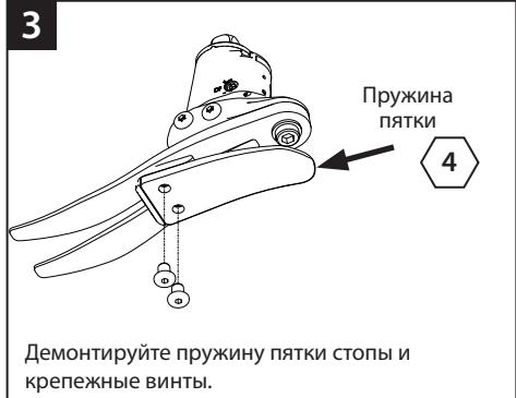
Демонтируйте пружину пятки стопы и крепежные винты.
