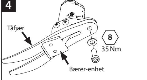
Fjern tåfjærskruen og skift ut tåproesen. Til remontering bruker du Loctite 243 (926012) og et moment på 35 Nm. Kontroller at tåfjæren er midtstilt på bæreren.
