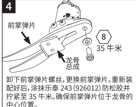
卸下前掌弹片螺丝，更换前掌弹片。重新装配好后，涂抹乐泰 243 (926012) 防松胶并拧紧至 35 牛米。确保前掌弹片位于龙骨的中心位置。
