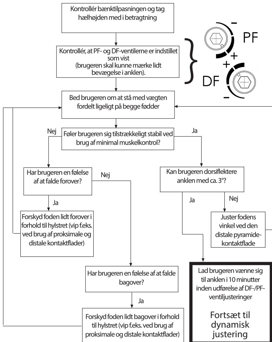
Brug forskydning til statisk tilpasning og stående stilling.
