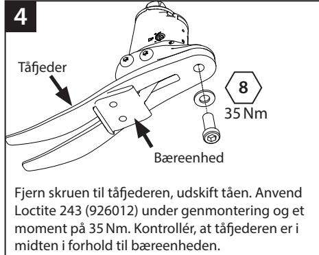
Fjern skruen til tåfjederen, udskift tåen. Anvend Loctite 243 (926012) under genmontering og et moment på 35 Nm. Kontrollér, at tåfjederen er i midten i forhold til bæreenheden.
