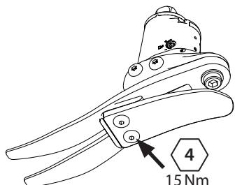
Remontér med ny hælfjær. Bruk Loctite 243 (926012) og et moment på 15 Nm.
