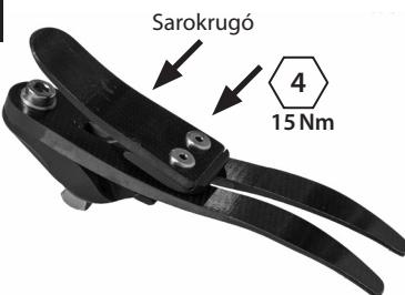
Szerelje a sarokrugót a tartóra, használjon Loctite 243 csavarrögítőt (926012), és húzza meg 15 Nm nyomatékra.
