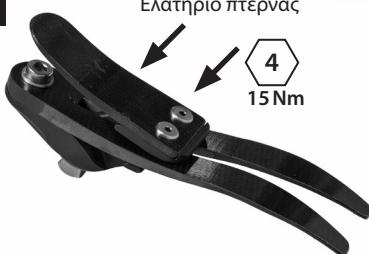
Συναρμολογήστε το ελατήριο πτέρνας επάνω στο στήριγμα, χρησιμοποιήστε Loctite 243 (926012) και σφίξτε με ροπή έως 15 Nm.
