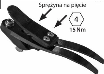
Zamontować sprężynę pięty na zespole nośnym, użyć kleju Loctite 243 (926012) i momentu obrotowego 15 Nm.
