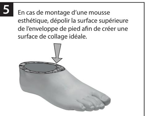
En cas de montage d'une mousse esthétique, dépolir la surface supérieure de l'enveloppe de pied afin de créer une surface de collage idéale.
