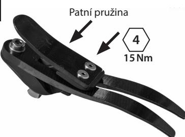
Namontujte patní pružinu na nosič, použijte Loctite 243 (926012) a utahovací moment do 15 Nm.
